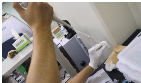
Fig. 18 ガラスキャピラリーの洗浄
