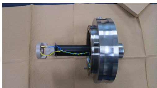
Fig. 13 取り外した API スタック
