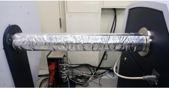
Fig. 24 サーマルジャケットの取り付け
