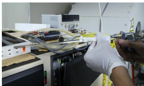
Fig. 19 窒素ガスで乾燥
