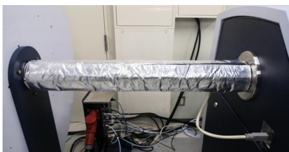
Fig. 24 サーマルジャケットの取り付け
