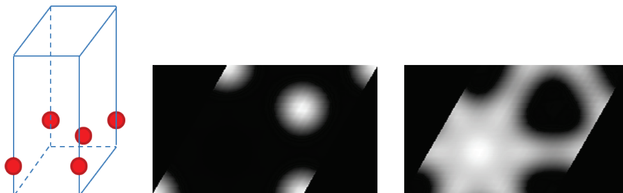
図3(a) グラフェンの単位格子、(b) HAADF シミュレーション像、(c) ABF シミュレーション像
