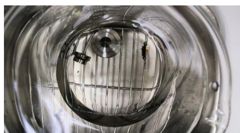
Fig. 16 メタノールによる超音波洗浄
