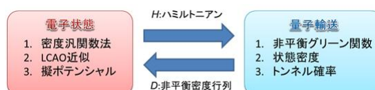
図1 第一原理電子状態・非平衡量子輸送シミュレーションの原理
