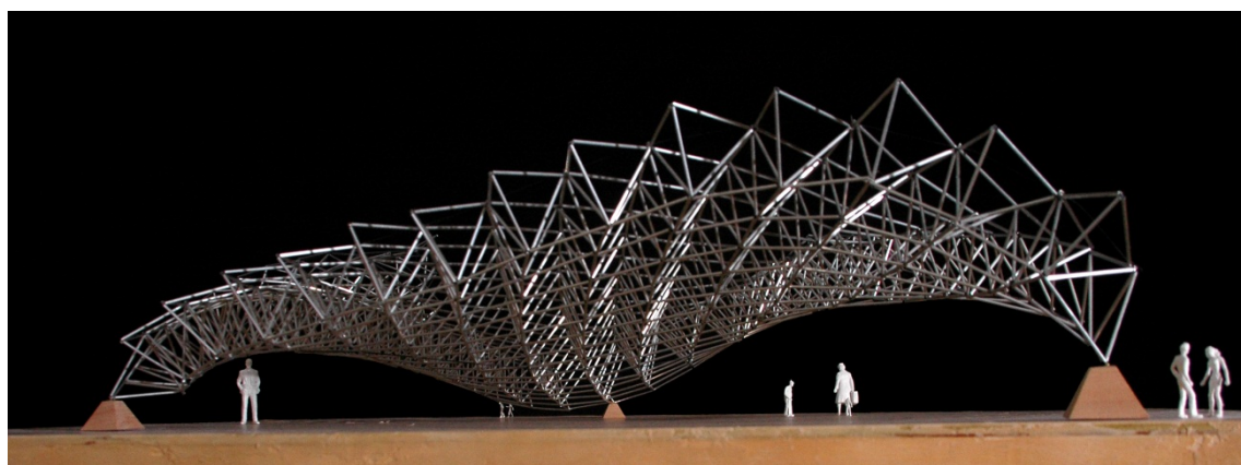
Fig.3-16 可変構造体の軸構成による剛体モデル 1
