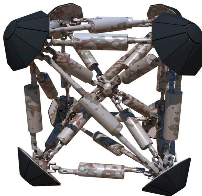
Fig.3-18 可変構造体軸部直動モデル(Tetrahedral Walker— http://ants.gsfc.nasa.gov/ )
