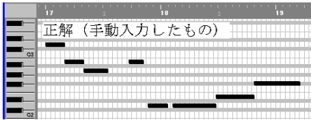
図 2 音量によって区切られたと推測される，複数音が 1 音に，1 音が複数音に変換された例（赤とんぼの「けーのあかとんぼ」） Fig. 2 Samples of segmentation mistake with note binding and divorcing.
