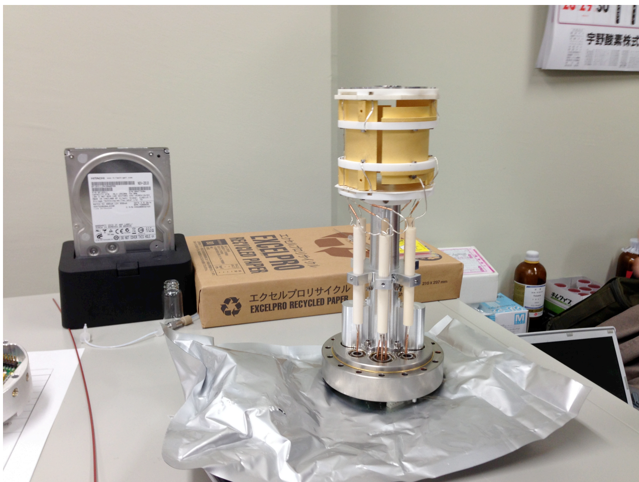
Fig. 6 本体から取り出した ICR セル
