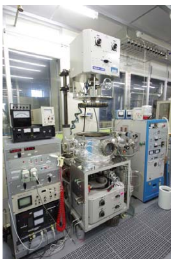
図.3 3極スパッタリング装置：アルバックサービス社製 SMR2304E
