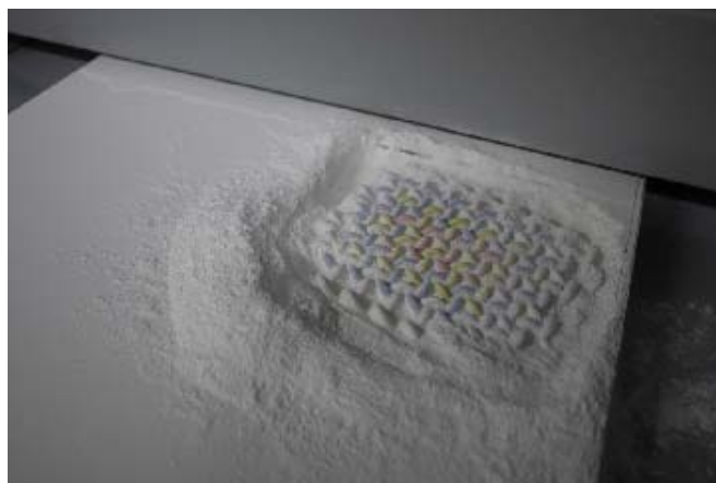
図 3. 造形台から造形物取り出し
