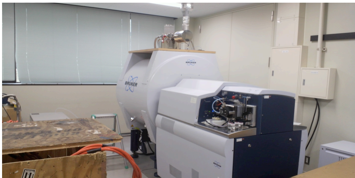
Fig. 3 消磁準備中の 9.4T FT-ICR MS (Solarix-JA)
