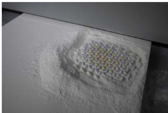
図 3. 造形台から造形物取り出し
