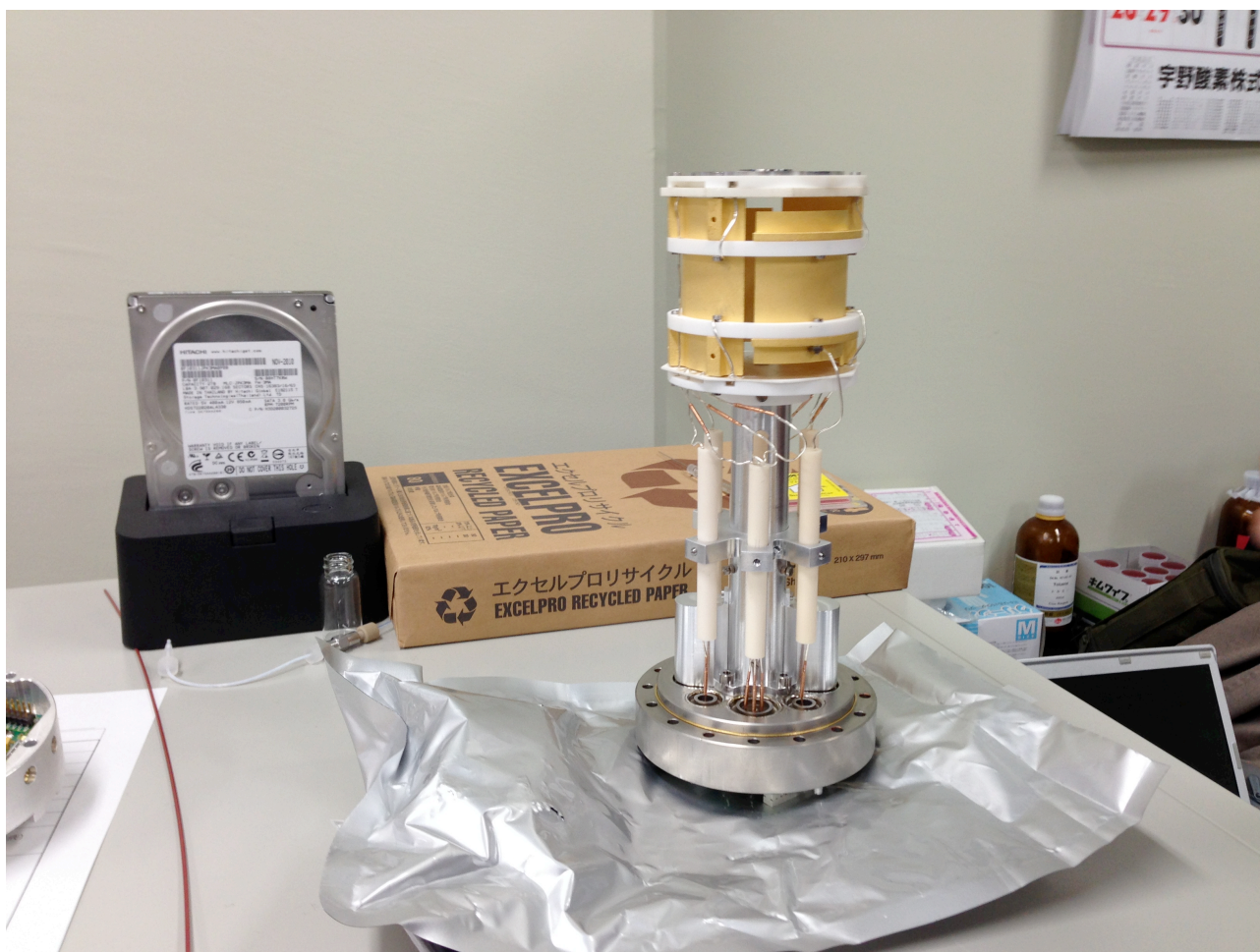
Fig. 6 本体から取り出した ICR セル
