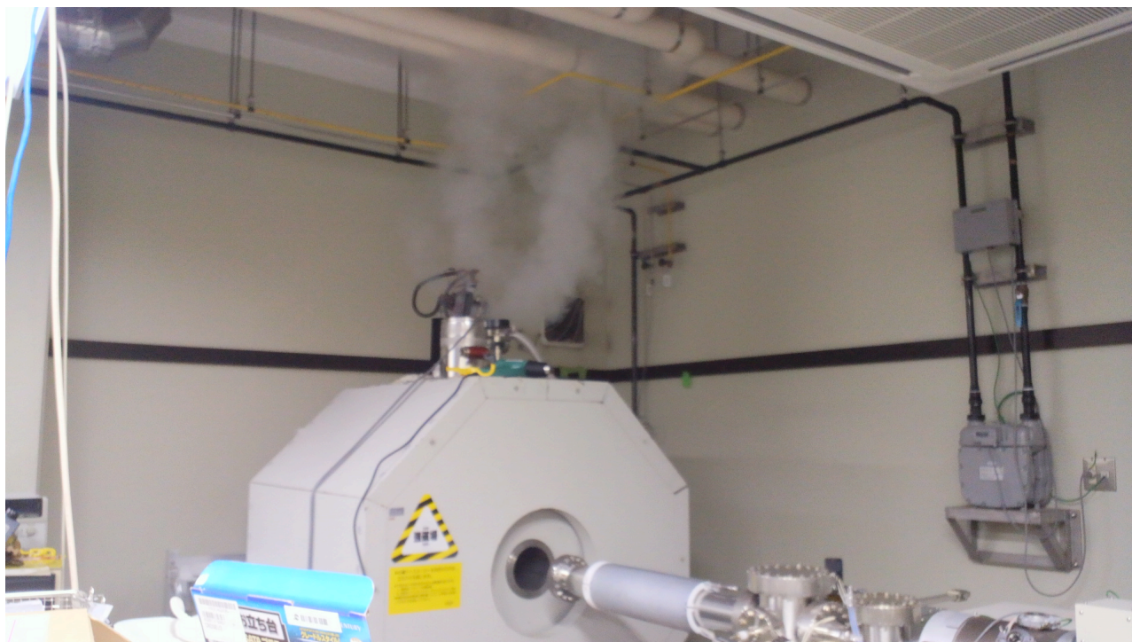
Fig. 2 消磁中の 7T FT-ICR MS (BioAPEX70e)
