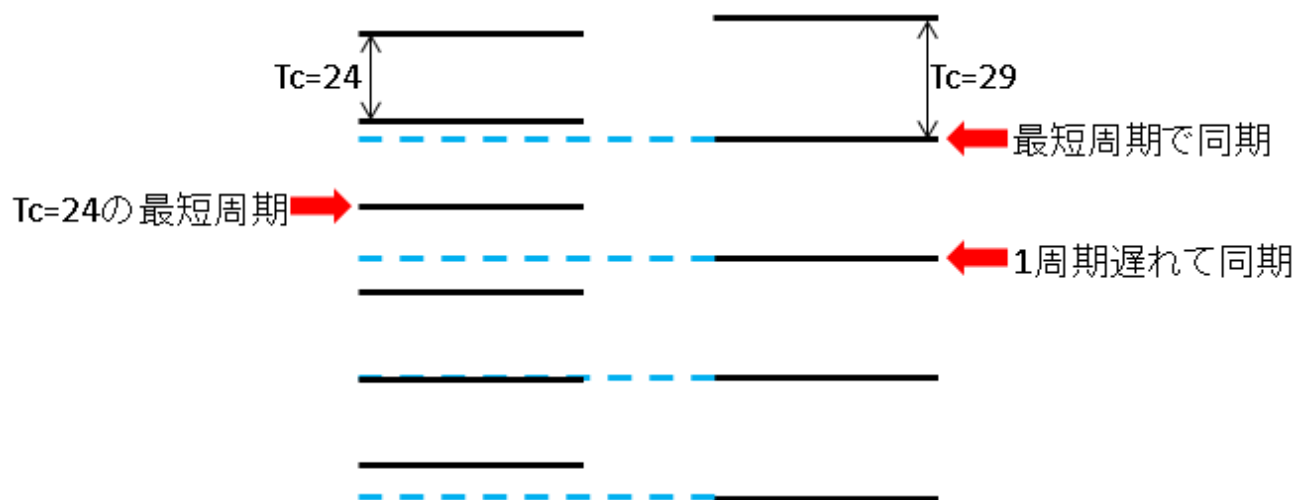
図 6.5: クロック周波数 T_c=24 と T_c=29 に設定した際の各クロックステップ毎の同期タイミング
