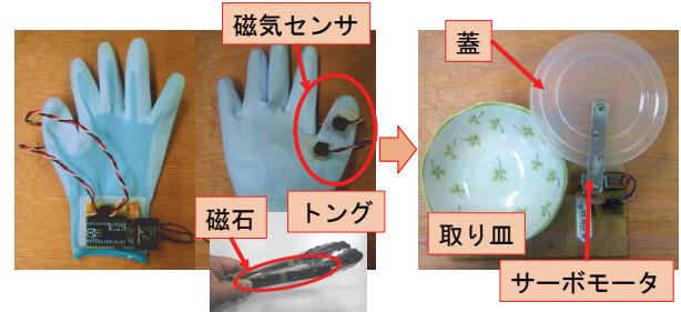
図6 GiantCutlery で使用する器具 Figure 6 Pieces of apparatus of GiantCutlery
