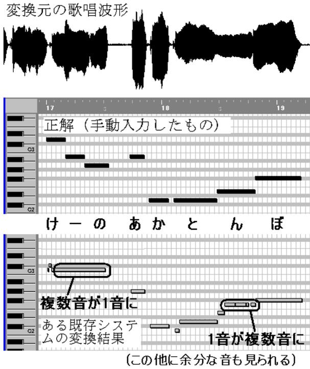
図 2.2: 音量によって区切られたと推測される, 複数音が1音に, 1音が複数音に変換された例 (赤とんぼの「けーのあかとんぼ」)
