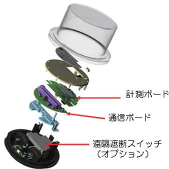
図 4 スマートメータの構造
