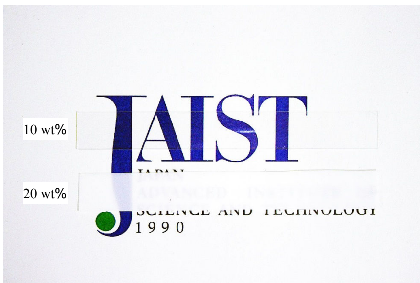
Fig.2-5 熱処理した PC/ p -tPh フィルムの透明性 (厚み 300 μm)
