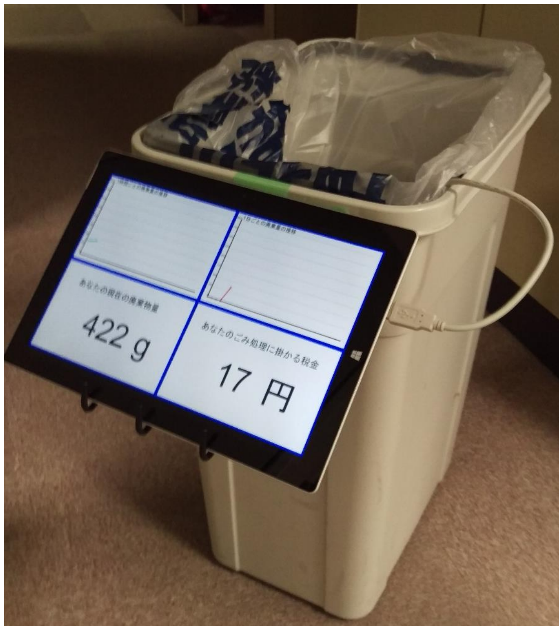
Figure21 作成したスマートゴミ箱のプロトタイプ
