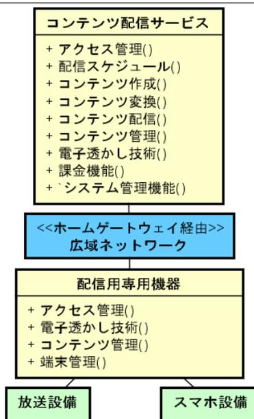
図 2.8 コンテンツ配信サービス構成図 (独立型)
