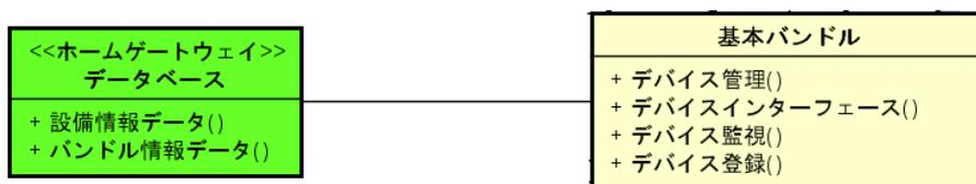
図 2.28 プラットフォームサービスホームゲートウェイ構成図
