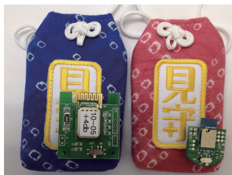
図 1 BLE ビーコン・格納用袋 (試作)
