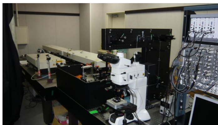
図3 北陸先端大学における共焦点光和周波顕微鏡システム [1][2]
