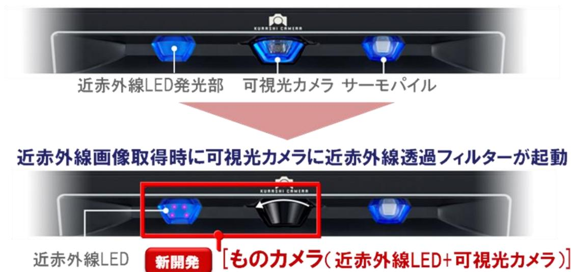
図 23 「近赤外線カメラと可視光カメラ」の構成
