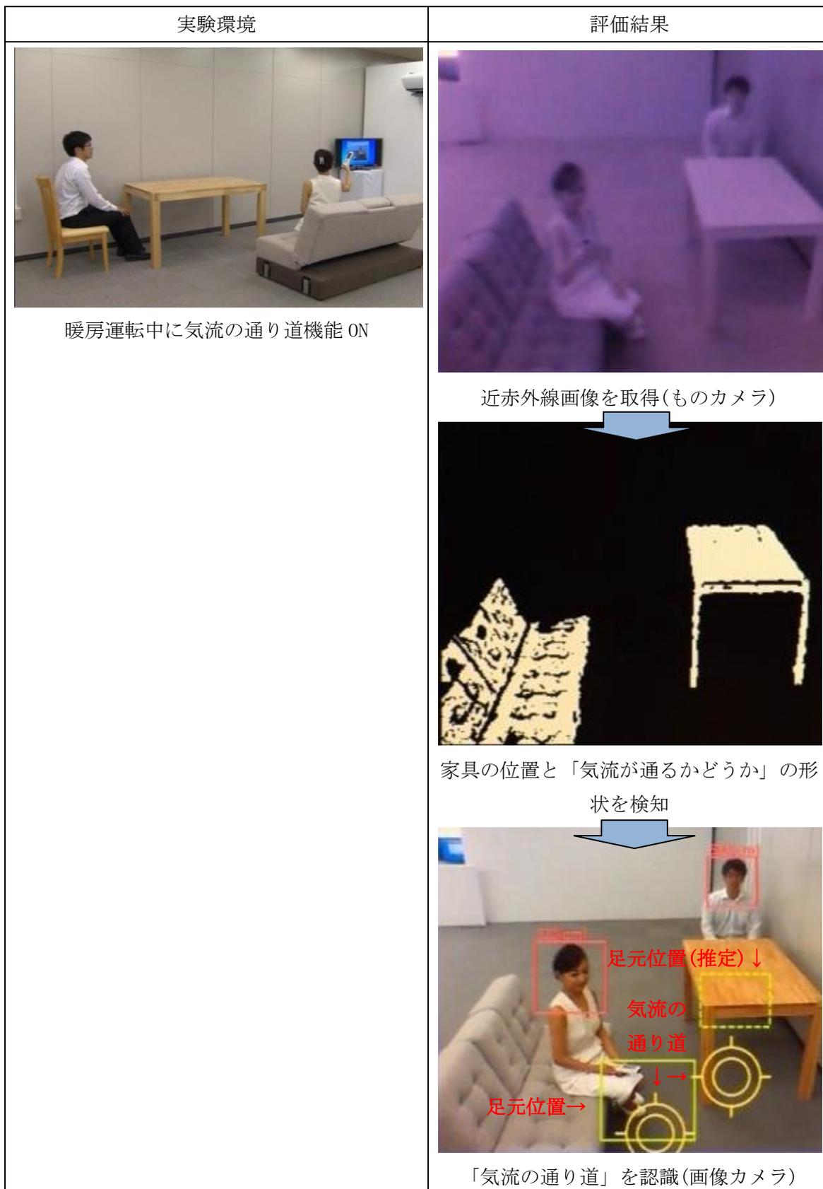
図 24 気流の通り道の認識結果
