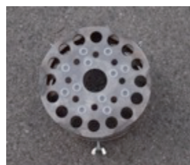
写真-8 作業台上での穴あけと穴あけジグ
