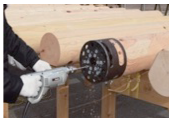
写真-8 作業台上での穴あけと穴あけジグ
