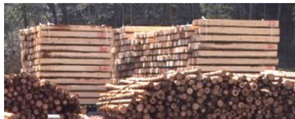
写真-5 太鼓落とし材の自然乾燥
