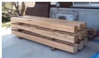
写真-4 栈積み乾燥試験
