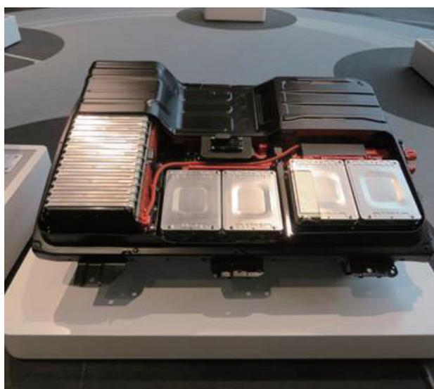
図1 日産電気自動車用パワートレイン (著者撮影) 図2 日産リーフのリチウムイオン電池 (著者撮影)
