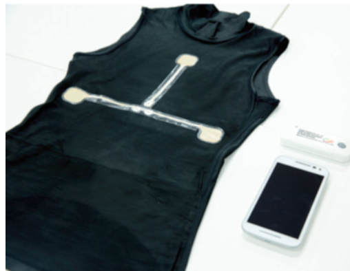
図5 心電図検査ができるシャツ型スマートウェア
