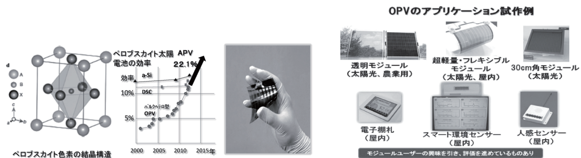
図2 ペロブスカイト太陽電池の結晶構造，効率向上，試作されたフレキシ基板モジュールとOPVの特徴と用途分野。
