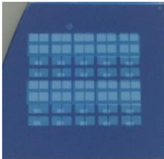
図 6.8 UV 射浸漬法により作製した簡易構造 TFT の上部写真
