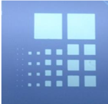
図 6.7 InO ゲルのパターニングと同様の条件で行った ITO ゲルのパターニング結果
