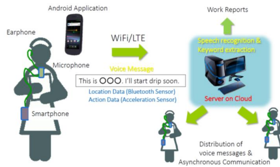
図 6-1. SVM システム概略図([2]より引用)
