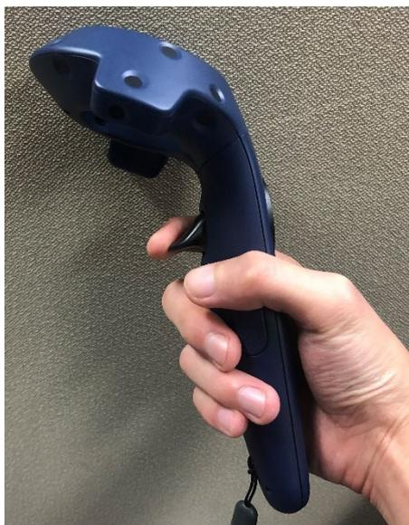
図 3-3. VIVEPRO のコントローラー (人差し指の下はトリガーである。)
