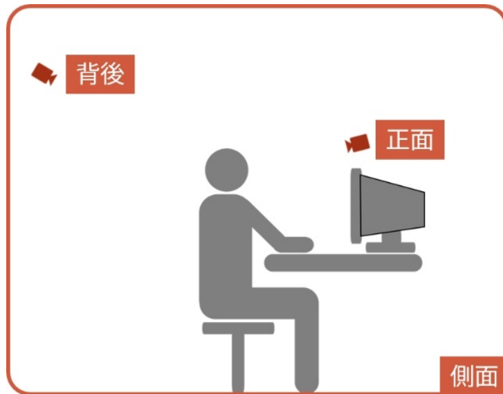
図 4 実験におけるビデオカメラの配置
