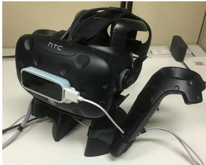
図 4.1: HTC VIVE に Leap Motion を取り付けた様子
