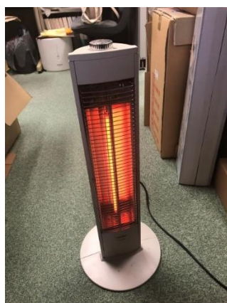
図 6-3 炎をシミュレートする電気ヒーター
