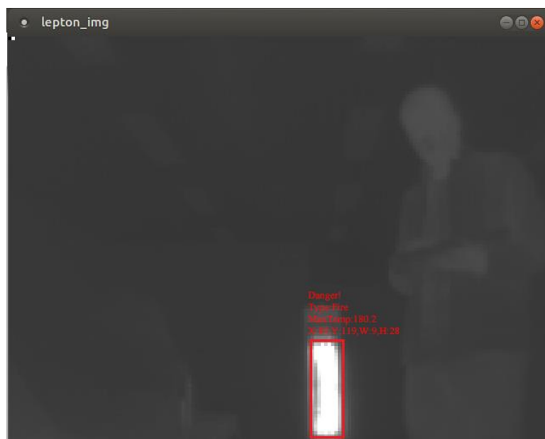
図 6-12 異常温度検知する時の様子（発火）
