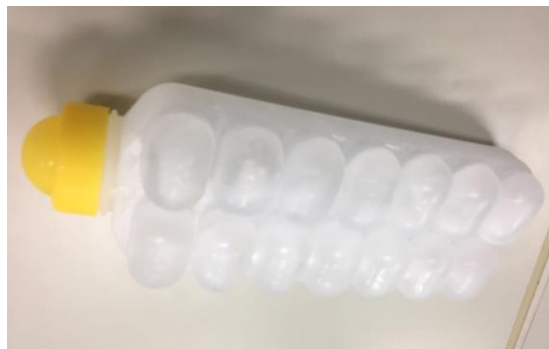
図 6-5 異常の低温をシミュレートする製氷皿
