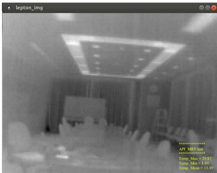
図 6-14 環境の平均輻射温度を計測様子
