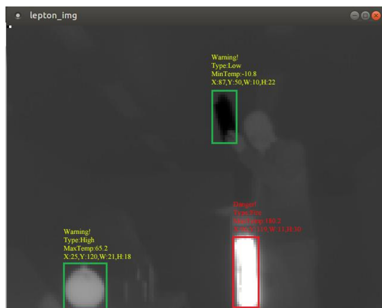
図 6-13 異常温度検知する時の様子（複数目標）
