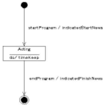
図 5.11: TimeKeeper の状態チャート図
