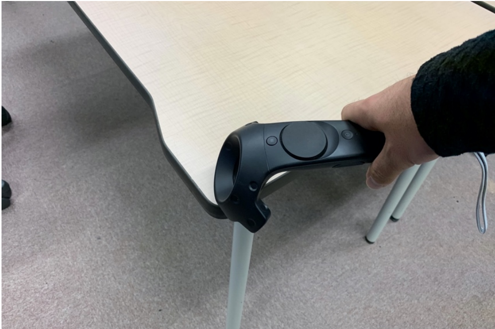
図 13：Vive コントローラを用いた机の座標取得
