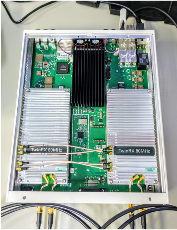
図 3.8 USRP X310 内部に TwinRx2 枚が装着されている様子
