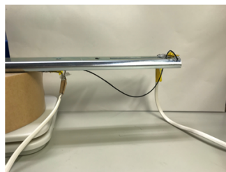
13. 移動－随時移動 （スライドレール） 引き出し量：半分
