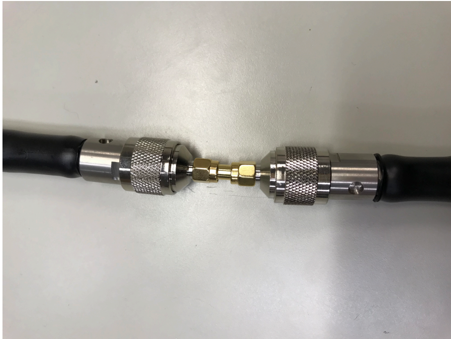
図 4.7: N 型-SMA 型変換コネクタの測定
