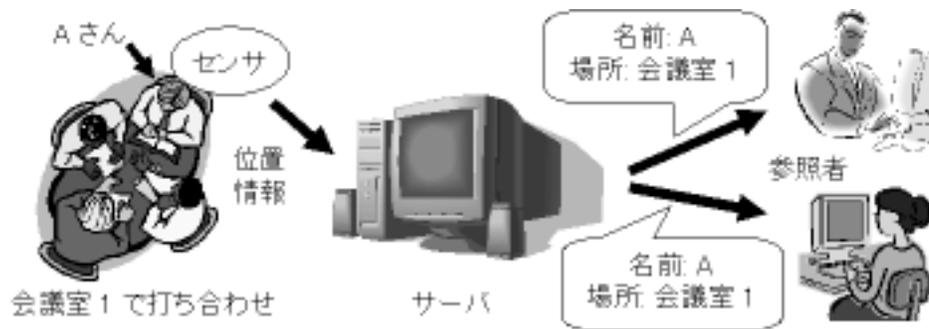
図 2.1: 赤外線位置検知システムの利用例
