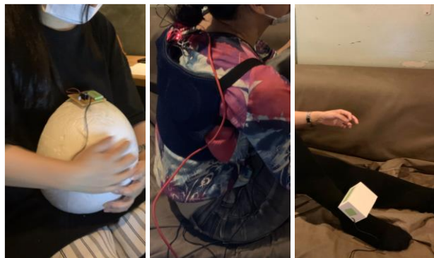
図6: Touch Love を装着した写真。(上左: 母親役の腹部に加速度センサを装着して撫で動作を行っている様子, 上右: 胎児役が背中側に振動子を搭載したジャケットを着用した様子, 下: 胎児役が足部にケースに入れたセンサ基板を装着した様子)
