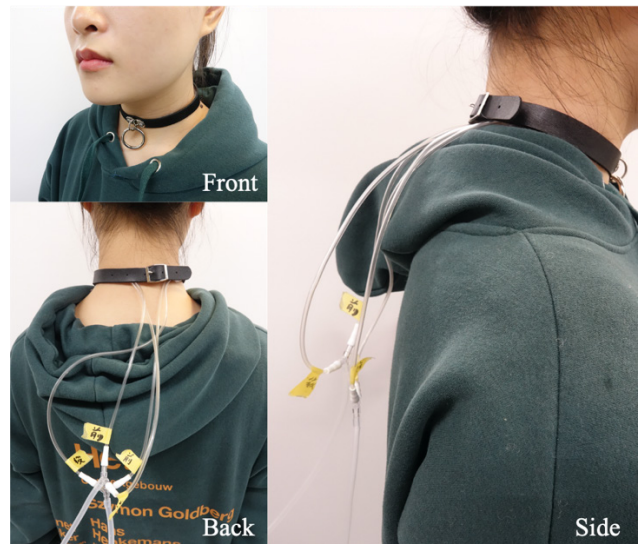
図 1 空気圧アクチュエータを用いた NaviChoker
