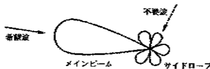
図 4.1: ビーム操作による希望波補足
