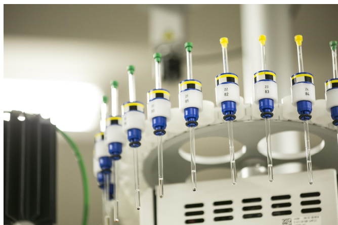
図1 NMR 施設に設置されている自動サンプルチェンジャー
