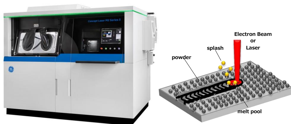
図 2 PBF 装置（左）とその造形原理（右）
