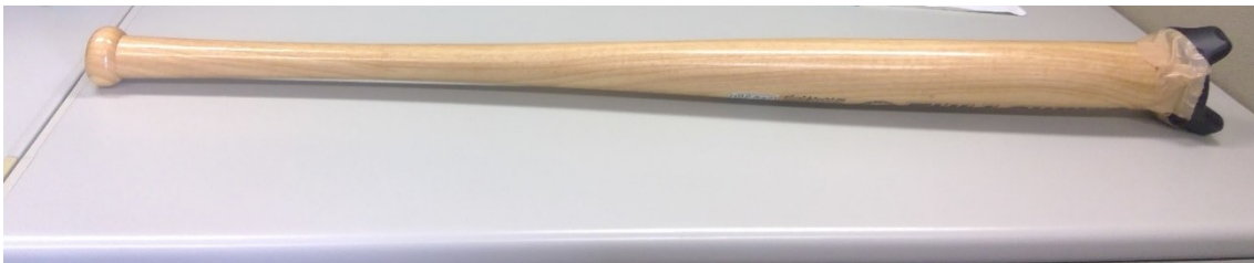
図 18 トラッカーを取り付けた木製バット
