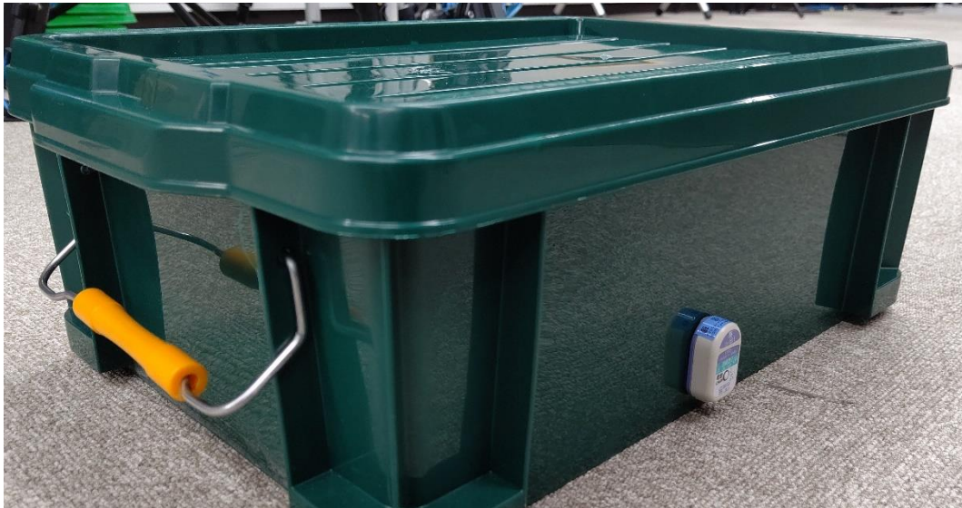
図 4 加速度センサ取り付け位置
