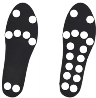
図 4 圧力センサの増設 (左: 改良前, 右: 改良後)
