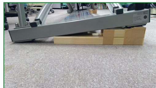
図 8 スキーシミュレータへの傾斜の付与
