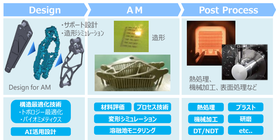
図1 金属AMの設計・製造プロセスと関連技術
