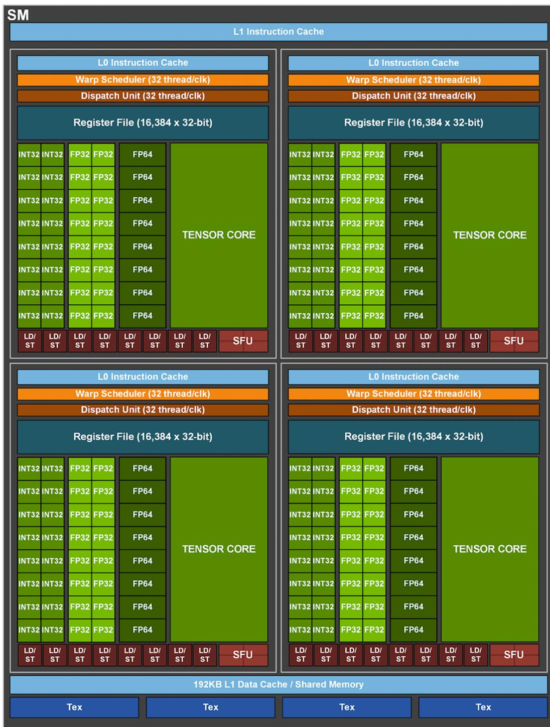
図 2.5: NVIDIA A100 Streaming Multiprocessor (SM) アーキテクチャ [18, p.17, 図 5]
