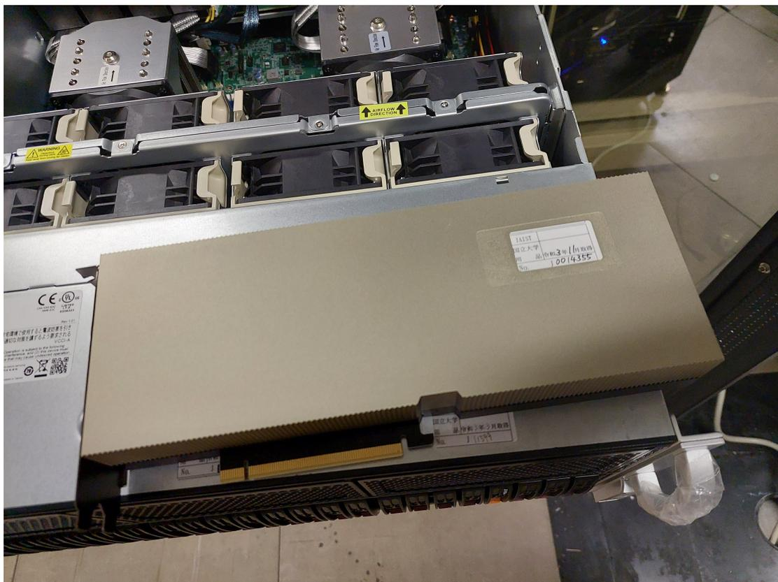
図 2.2: NVIDIA A100 PCIe GPU
