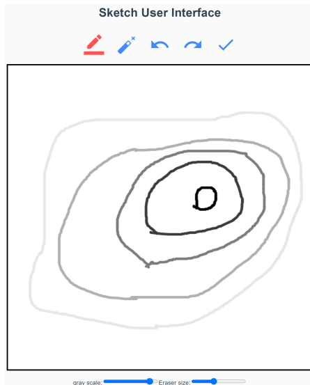
図 5 実装したユーザインターフェース. 上部のメニューアイコンは, 左から描画するブラシ, 消しゴム, 作業を1つ戻す, 作業を再び進める, セーブの機能を表す. 下部のバーではグレースケールの濃淡や消しゴムの大きさを調整することができる.
