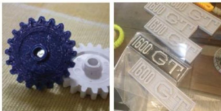
図 3.9：修理パーツを作成する例
