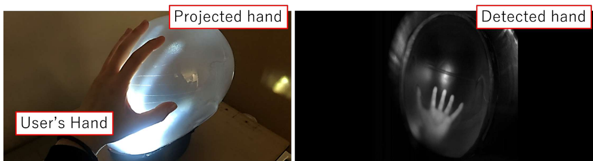
Figure 5.4: 赤外線カメラで取得した手のひらの様子
