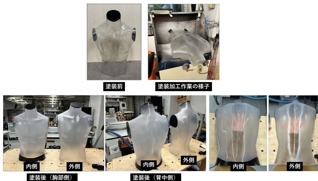
Figure 4.9: 上半身型ディスプレイの内外側塗装の比較
