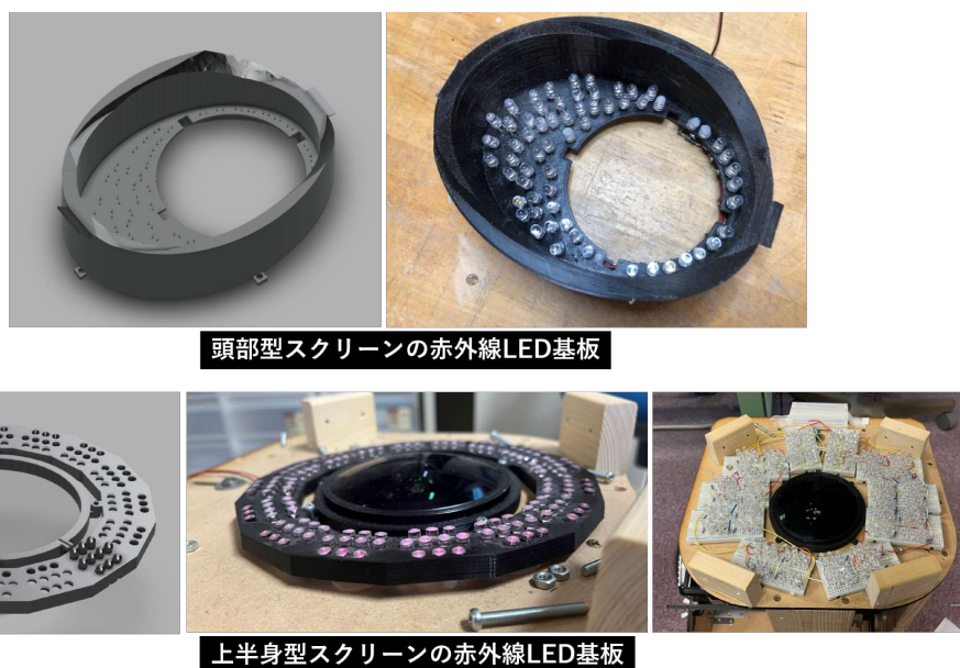
Figure 4.15: 赤外線 LED を基盤に配置した様子
