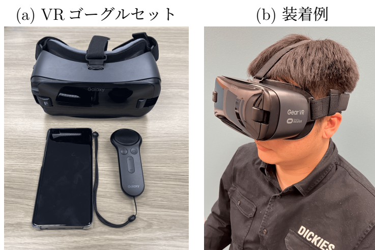
図 2.2: コンピュータ・グラフィックス VR 暴露療法の装置
