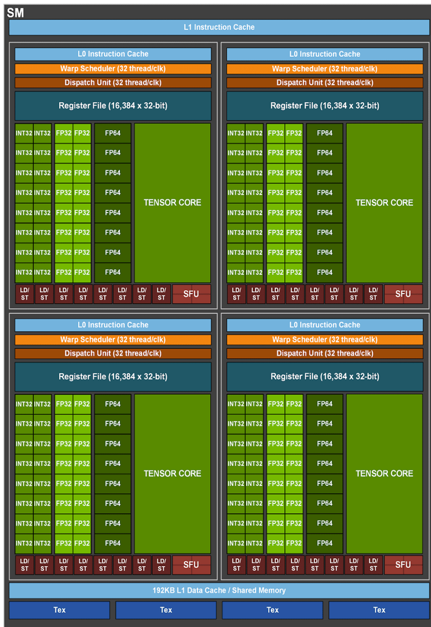
図 2.3: NVIDIA A100 の SM のアーキテクチャー ([3] の図 4 から引用)
