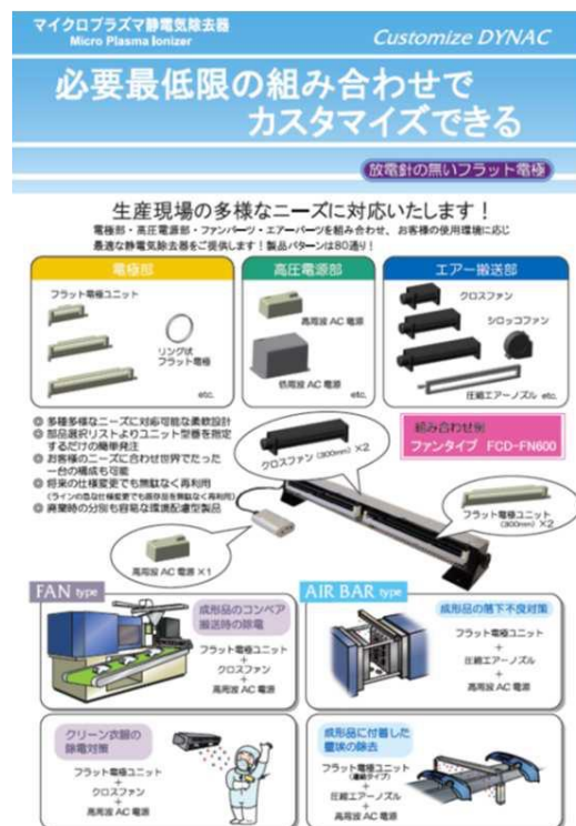
図5: 部品モジュールを公開し、顧客が各モジュールを選ぶ形で、カスタマイズ注文を受ける仕組みを導入したイオナイザー
